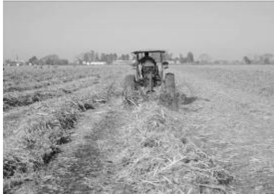
Figura 3. Rastrillo hilerador modificado para el acondicionamiento del residuo de la cosecha previo al paso las máquinas enfardadoras.
