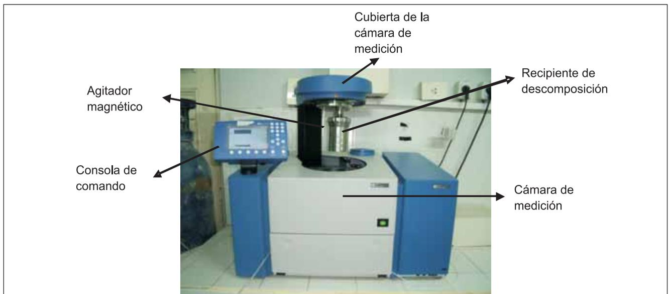
Figura 1. Bomba calorimétrica IKA, C5012.
