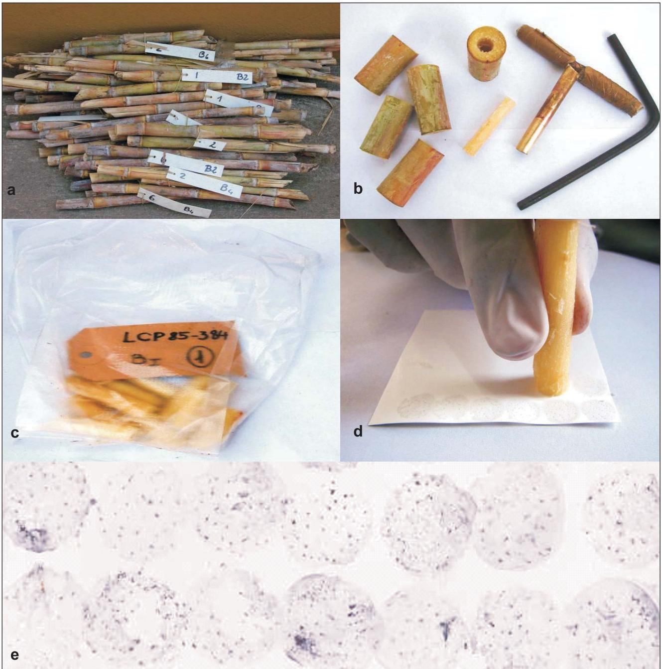
**Figura 2. Procesamiento de muestras de caña de azúcar. a) Recepción y codificación de muestras en invernáculo. b) Extracción del cilindro central del tallo con sacabocado. c) Acondicionamiento de muestras para su procesamiento en el laboratorio. d) Impresión del cilindro en la membrana de nitrocelulosa. e) Visualización de la reacción antígeno-anticuerpo (positiva) por coloración de los haces vasculares colonizados.**
