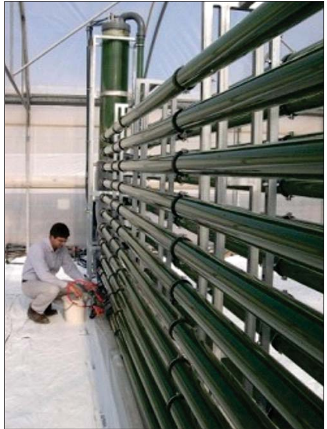
Figura 3. Cultivo de microalgas en fotobiorreactores tubulares cerrados, en la Estación Experimental de Las Palmerillas (Fundación Cajamar), Almería, España.
