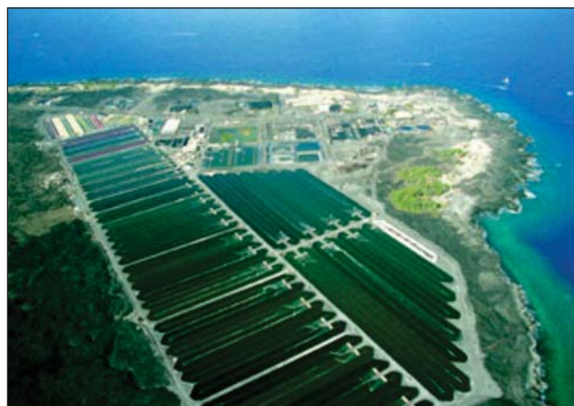
Figura 1. Estanques poco profundos (aproximadamente de 20 cm de profundidad) y abiertos, pertenecientes a una granja acuática en Cyanotech Corporation (Hawaii, EE. UU.).
