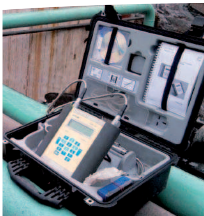
Figura 1. Caudalímetro ultrasónico portátil no invasivo, con convertidor de medición o unidad indicadora/registradora de flujos.
