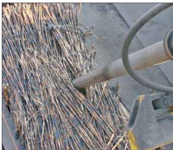
Figura 4: Toma de muestra con el Core Sampler.
