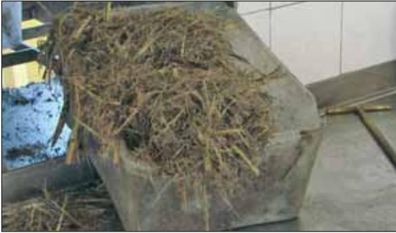
Figura 6: Muestra después de pasar por el desfibrador.
