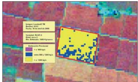
Figura 3: Clasificación provincial de niveles de producción superpuesta sobre la imagen Landsat 5 TM, composición RGB: 4-5-3.
