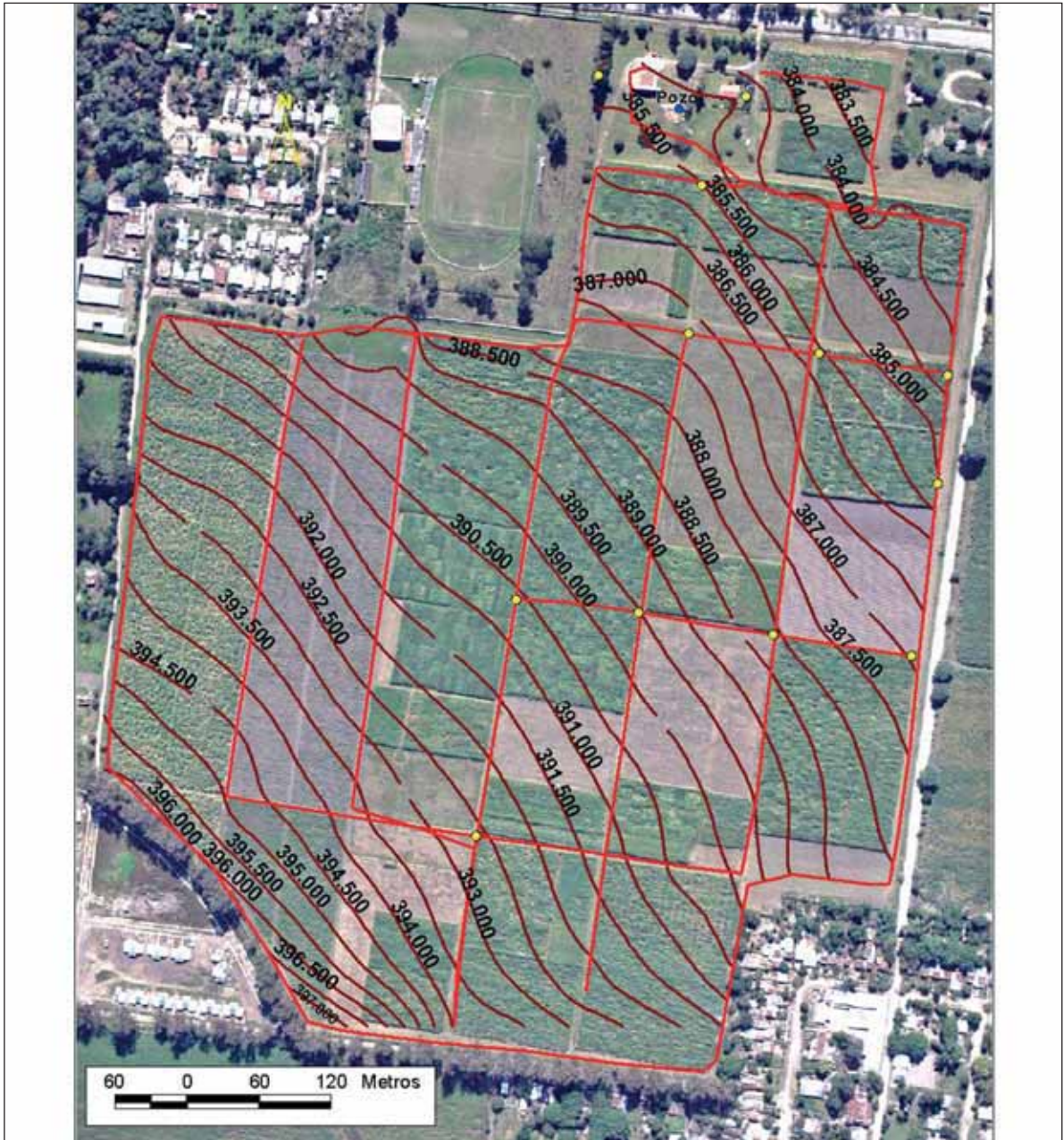
Figura 11: Curvas de nivel con una equidistancia de 0,50 m. Subestación Santa Ana - EEOC.
