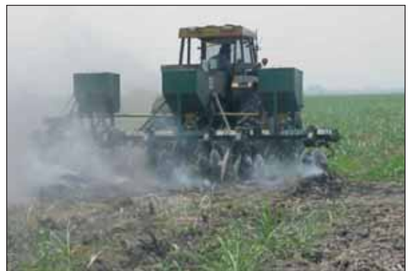
Figura 6: Equipo para la aplicación de fertilizante sólido, ancho de labor de tres surcos.
