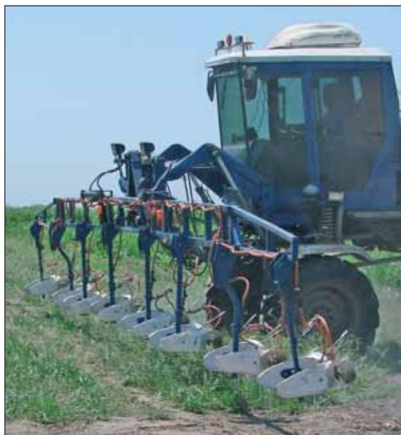
Figura 6. Barra pulverizadora cañera.
