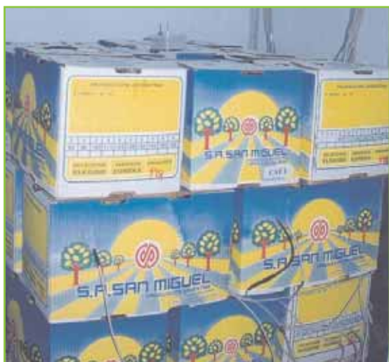
Figura 2. Distribución de las cajas de frutas con los sensores de pulpa de fruta simulando un pallet de exportación.
