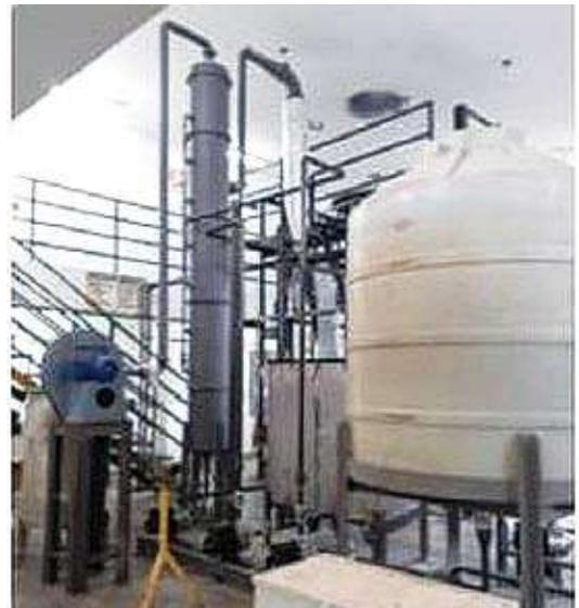
**Figura 52.** Ventilador de tiro Inducido (VTI).
