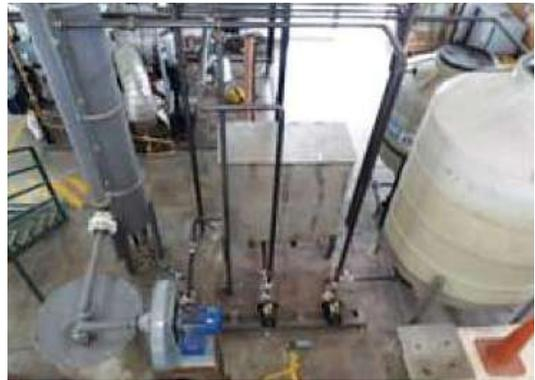
**Figura 51.** Sistema de limpieza de gases pobres producidos en el reactor de gasificación de biomasa.
