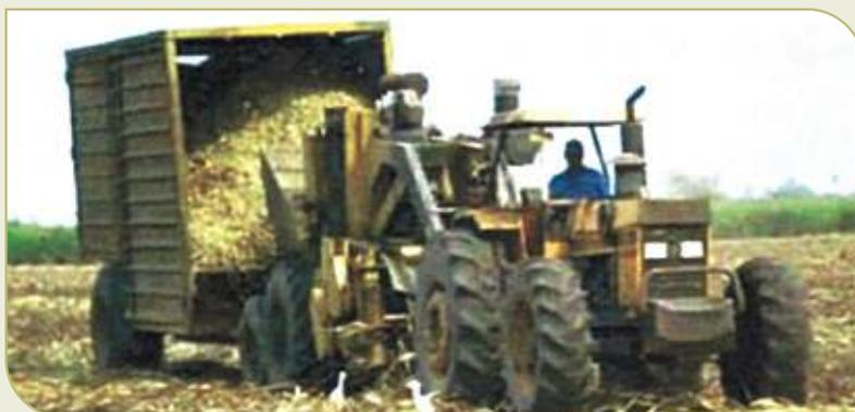
**Figura 28.** Tren de levantamiento, picado y almacenado del RA.
