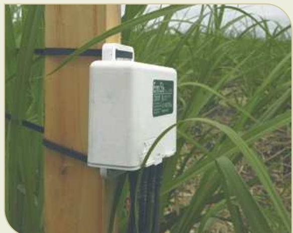
**Figura 9.** Sensor de humedad edáfica automático. Simoca, 2012.
