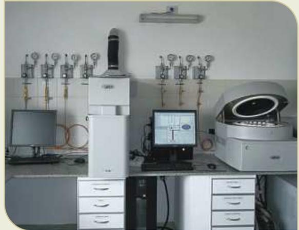
**Figura 29.** Equipos de termogravimetría y fusión de cenizas.
