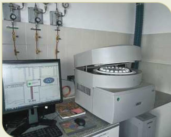
**Figura 30.** Equipo de termogravimetría marca LECO, modelo TGA 701 instalado en el LEMI para la determinación simultánea del contenido de humedad, cenizas, sólidos volátiles y carbono fijo.
