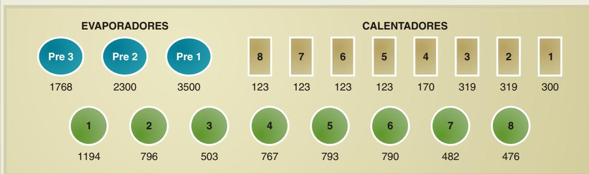
Figura 18. Esquema de disposición y áreas de los evaporadores y calentadores de jugo.
