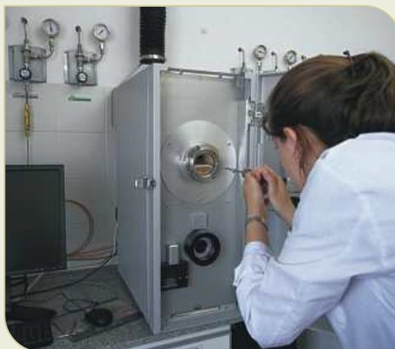
**Figura 31.** Equipo de termo fusión marca LECO modelo AF700 instalado en el LEMI para la determinación de la temperatura de fusión de cenizas de biomazas.
