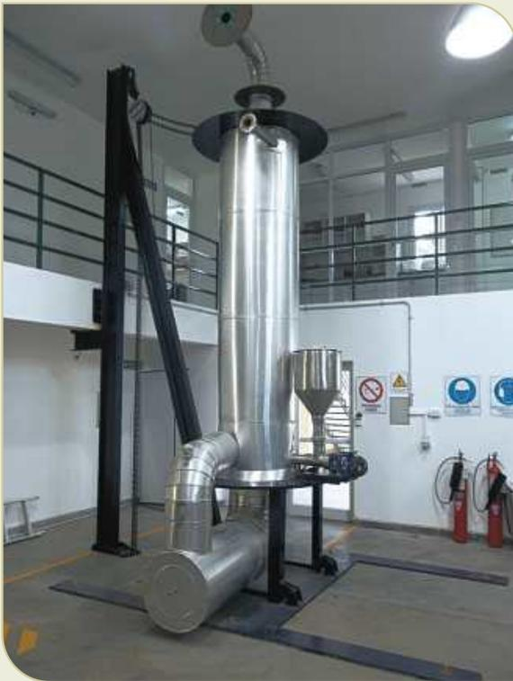
**Figura 28.** Equipo gasificador diseñado por la EEAOC.
