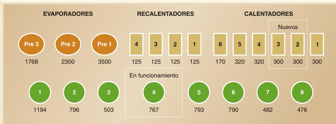
Figura 51. Esquema de disposición de los evaporadores y calentadores de jugo en el Ingenio 1 analizado.
