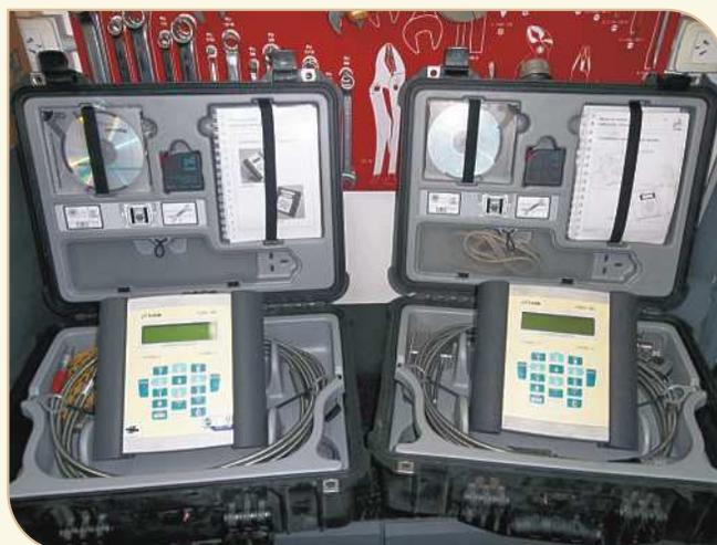
**Figura 43.** Nuevos medidores portátiles de flujos líquidos por ultrasonido.
