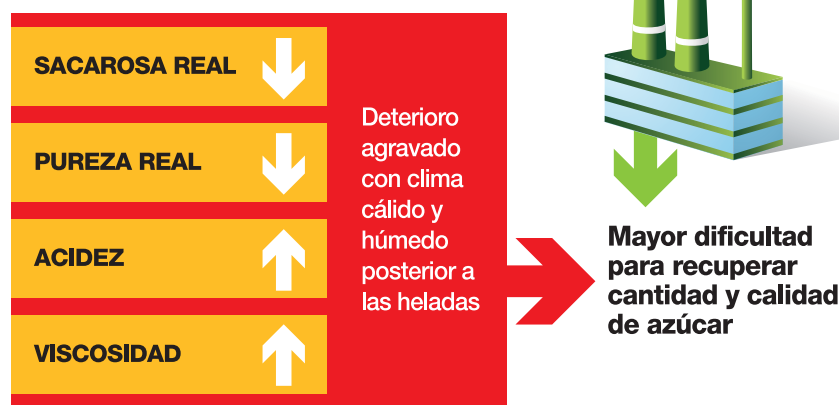
Figura 2. Esquema de los procesos que se desencadenan con el deterioro del jugo de caña de azúcar, provocado por heladas.
