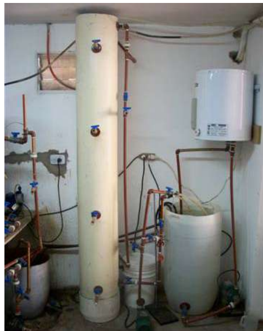
Figura 50. Biorreactor Anaeróbico tipo UASB de 150 litros.
