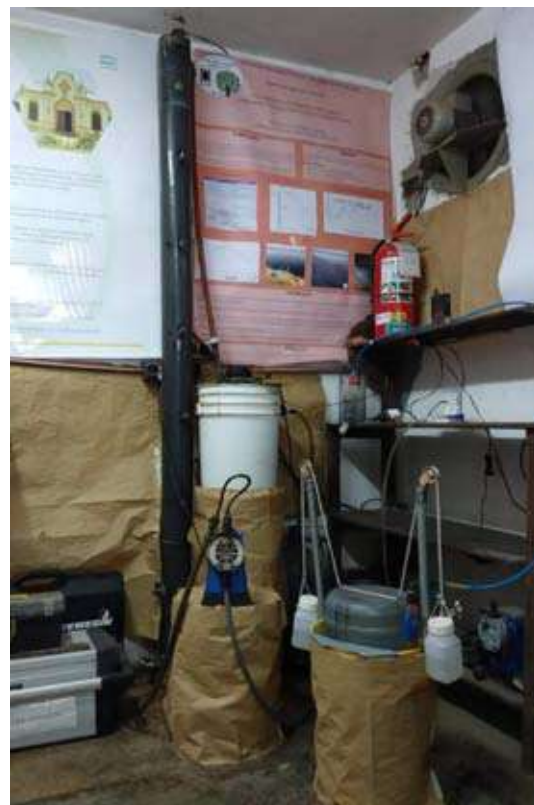
Figura 46. Biorreactor anaeróbico tipo UASB de 15 litros trabajando con vinaza.
