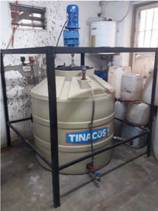
Figura 48. Biorreactor Anaeróbico tipo mezcla completa de 1000 litros.
