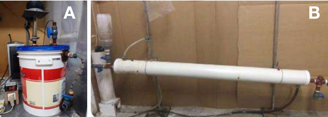
Figura 47. Biorreactores Anaeróbicos tipo mezcla completa (20 litros) y tipo tubular (10 litros)
