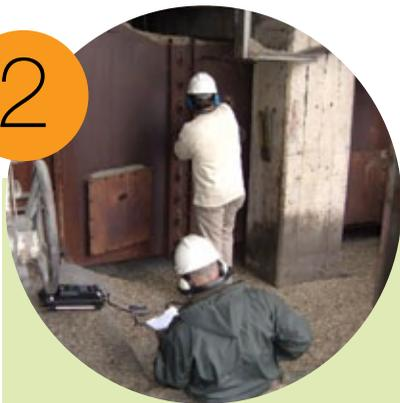
Análisis de gases en la salida del calentador de aire. Es necesario como mínimo medir: concentración de COppm, CO<sub>2</sub>%, O<sub>2</sub>%, factor de dilución ( $\lambda$ ), temperatura (TH) y presión de los gases (PH). Valores normales para calderas convencionales: CO = 0 a 300 [ppm]; CO<sub>2</sub> = 5 a 20%; O<sub>2</sub> = 8 a 20%;  $\lambda$  = 1,7 a 2,2; TH = 140 a 190 [oC] y PH = - 250 a -300 [mmCa].
