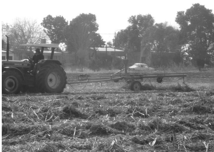
Figura 2. Rastrillo hilerador para el acondicionamiento del residuo de la cosecha previo al paso de enfardadoras.
