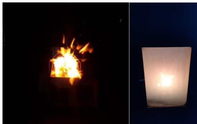
Figura 3: Ensayo de Combustión (Izq. Quemador industrial con pellet de RAC y Der. Estufa con pellet de olivo) Fte: INTI 2019, 2022.
