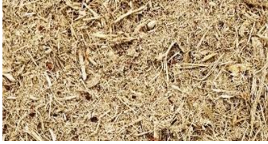
Fig. 2 - M1-BCA, Muestra de bagazo de descarte con 10% de material no deseado s/LBC.
