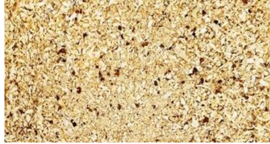
Fig. 3 - M2-APT, Muestra de aserrín con 5 % de material no deseado s/LBC.
