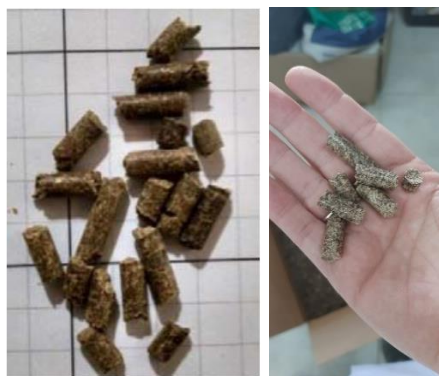
Figura 2: Pellets elaborados con residuos lignocelulósicos (Izq. RAC y Der poda de olivo).
