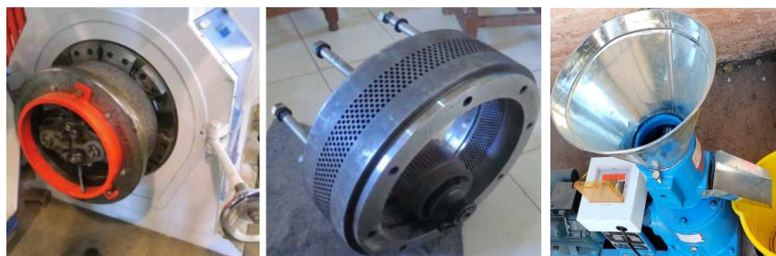
Figura 1: Prensas peletizadoras (Izq. Utilizadas para RAC; Der. Utilizada para para olivo) Fuente: INTI 2017 y 2020.
