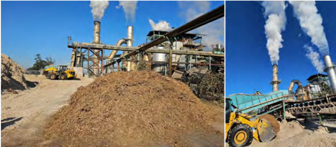
Figura 5. Ensayo de combustión de mezcla de bagazo con tallo de tabaco en caldera bagacera.
