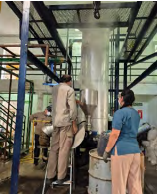
Figura 2. Reactor de gasificación de biomasa diseñado por técnicos de la EEAOC.
