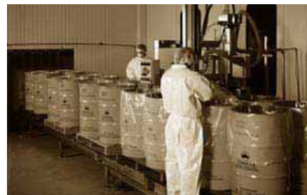
Proceso de envasado de aceite esencial de limón en recipientes metálicos inoxidables de 205 litros.
