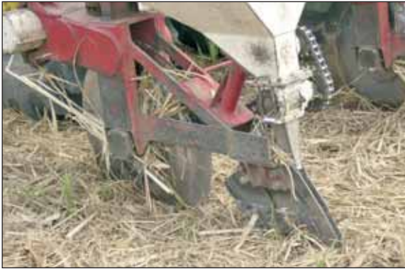
Figura 9: Equipo para aplicar abonos sólidos en campos con cobertura de residuo de cosecha.
