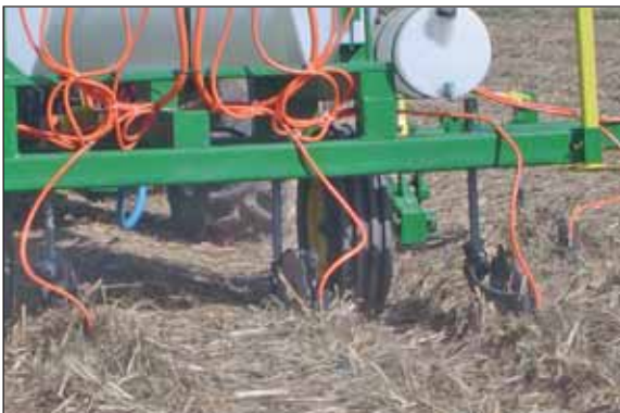
Figura 10: Equipo para aplicar abonos líquidos en campos con cobertura de residuo de cosecha.
