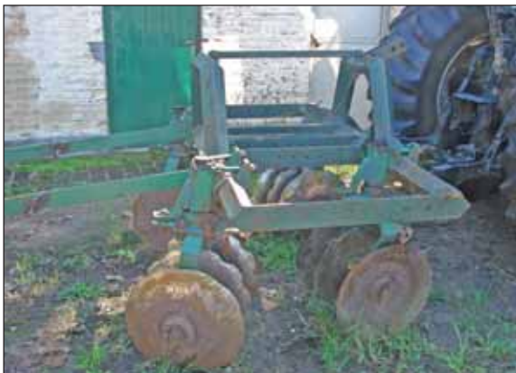
Figura 5: Equipo de cuatro paquetes utilizado para el picado de trocha.
