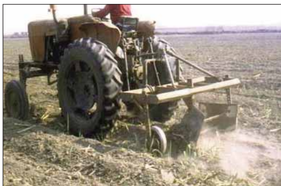
Figura 1: Equipo desboquillador empleado en Tucumán.
