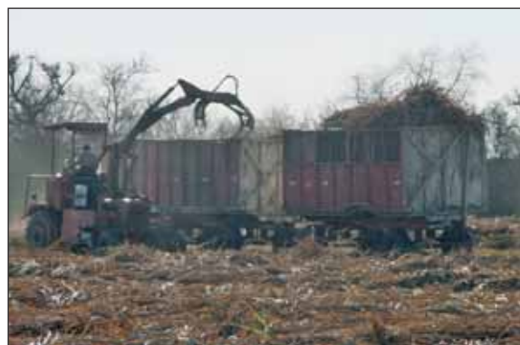
Figura 3: Cargadora de caña en una cosecha semimecanizada.
