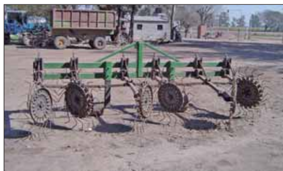
Figura 8: Equipo para retirar el residuo de la línea de brotación de los surcos.
