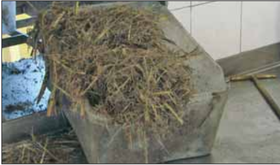
Figura 6: Muestra después de pasar por el desfibrador.
