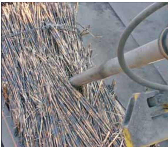
Figura 4: Toma de muestra con el Core Sampler.
