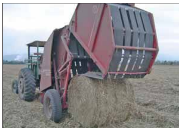
Figura 14: Equipo para enfardar el residuo de la cosecha de la caña de azúcar.
