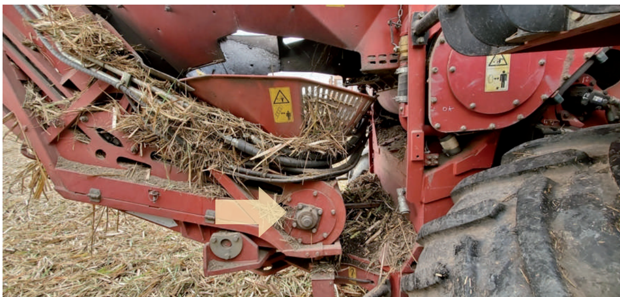
Figura 19. Pérdida de caña troceada que cae del canasto o mesa de la cosechadora. Tucumán, 2022.
