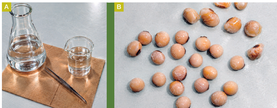
Figura 4. Test de lavandina A) Elementos necesarios para realizar el test. B) semillas con daño mecánico vs semillas sin daño.
